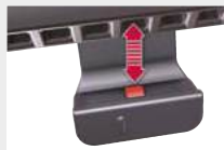
Fixierbare Trennsteg für auf der Seite liegende Anordnungen und Anwendungen mit großen Querbeschleunigungen – keine zusätzlichen Abstandhalter notwendig
